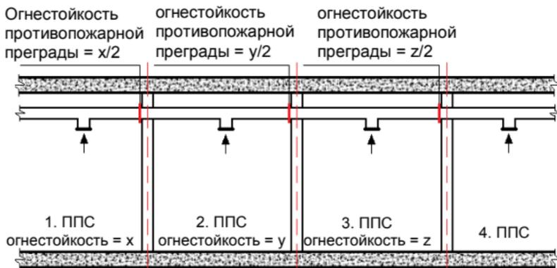
Если противопожарная преграда не соответствует требованиям к изоляционной способности (I), необходимо сделать противопожарную изоляцию. Требования к изоляционной способности (I) противопожарной преграды не предъявляются, если площадь поперечного сечения канала  $\leq 200 \text{ см}^2$ .
